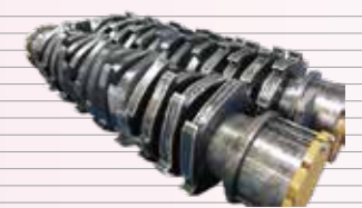
■刃物交換工事(メンテナンス)
